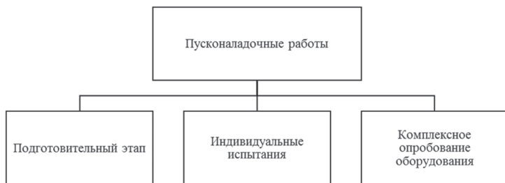
Рис. 1. Этапы выполнения пусконаладочных работ
